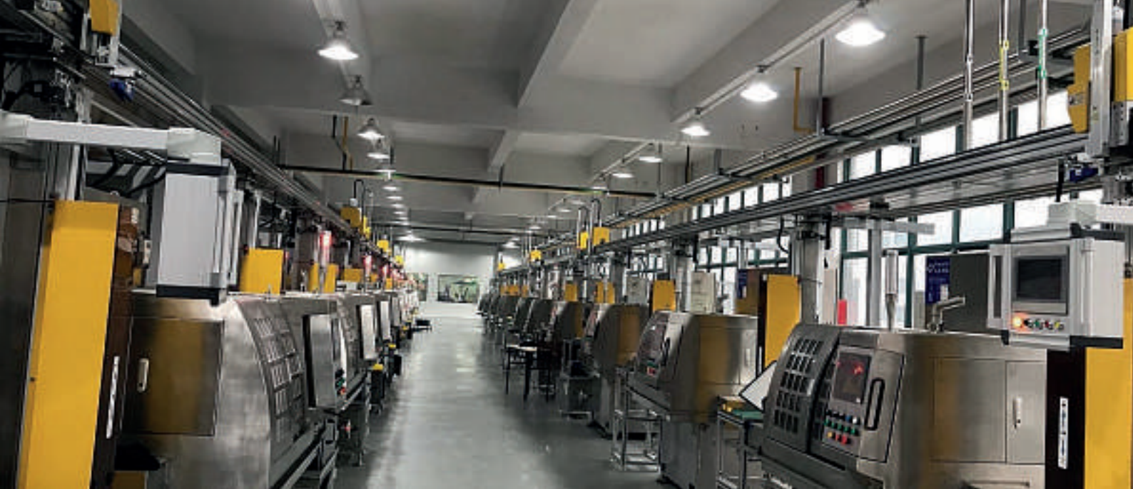
Fertigungsstraße für Wälzlager mit Schleifmaschinen von Zhonglun. Foto: Transfact
